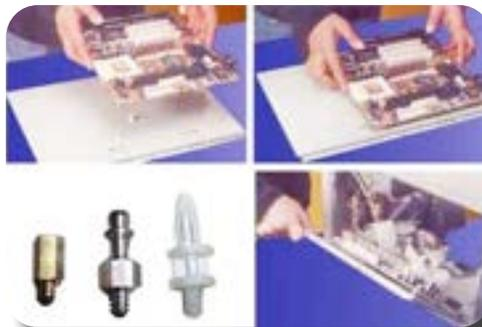
*Gambar Pemasangan Motherboard*
