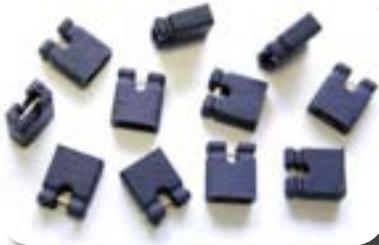
Jumper merupakan komponen kecil yang diletakan pada mainboard sebagai pengatur CPU dan tegangan yang masuk ke dalam mainboard. Pengaturan jumper yang salah bisa berakibat rusaknya processor. Jadi berhati-hatilah saat memasang jumper ini dengan memastikan anda memasangnya dengan benar. Cara memasangnya, anda cukup memperhatikan bentuk lubang dan dan socket yang tersedia. Saat memasang jumper ini, pastikan tidak ada aliran listrik.
