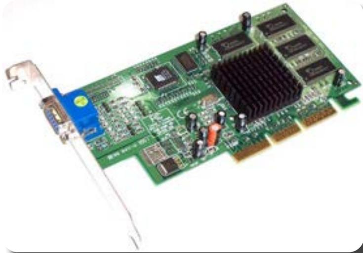
VGA Card jenis ini merupakan VGA untuk motherboard jenis lama seperti motherboard untuk prosesor Pentium 4. Jenis Motherboard untuk VGA Card AGP ini biasanya port Slot nya berwarna coklat.
