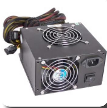
**1.Masalah :** Setelah dihidupkan PC tidak bereaksi apa-apa, tidak ada tampilan dimonitor, tidak ada lampu indikator (led) yang menyala, kipas power supply tidak berputar, lampu indikator pada monitor tidak menyala.
